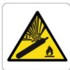
PERICOLO BOMBOLA PRESSURIZZATA
