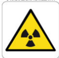
PERICOLO MATERIALE RADIOATTIVO O RADIAZIONI IONIZZANTI
