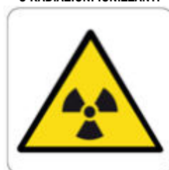
PERICOLO MATERIE RADIOATTIVE O RADIAZIONI IONIZZANTI
