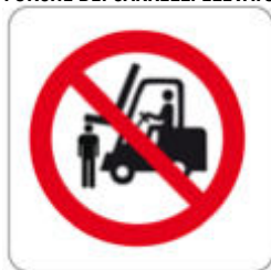
VIETATO SOSTARE/PASSARE SOTTO LE FORCHE DEI CARRELLI ELEVATORI
