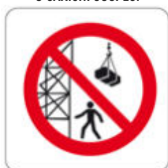
VIETATO PASSARE SOTTO PONTEGGI O CARICHI SOSPESI
