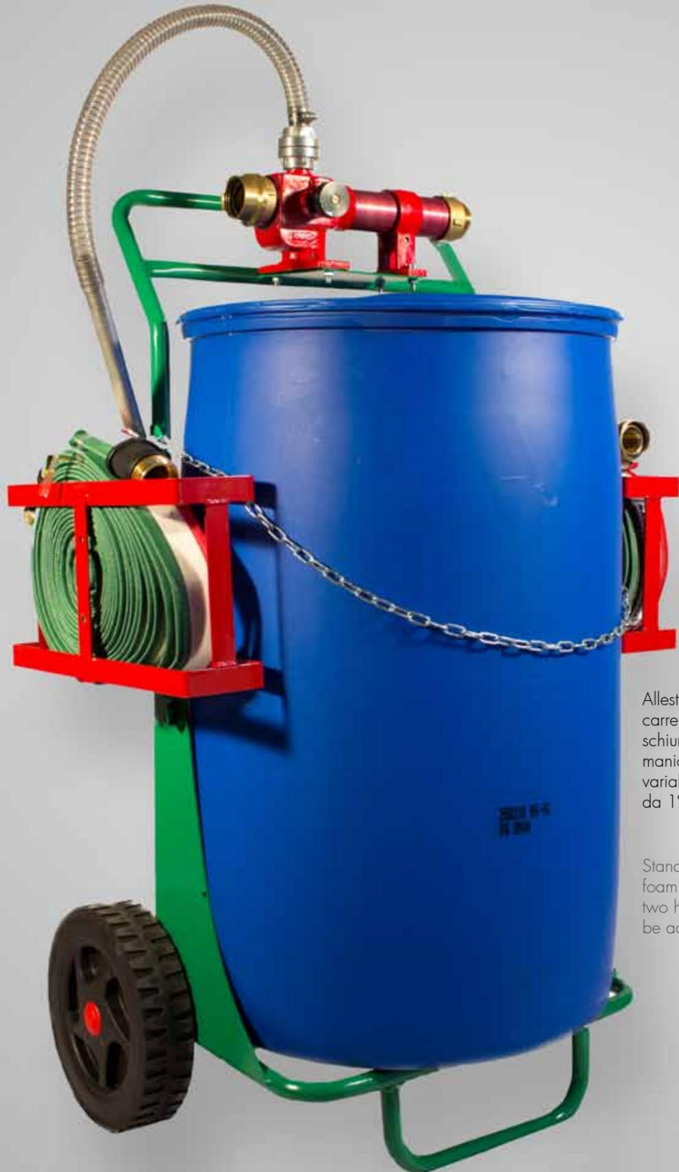
Allestimento standard completo di carrello, fusto di schiumogeno, lancia schiuma a bassa espansione, due manichette da 20m e miscelatore variabile con possibilità di regolazione da 1% a 6%
